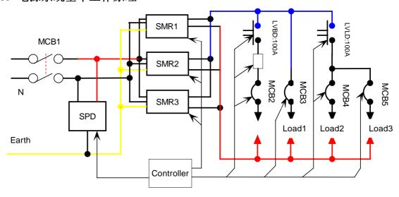
图 2 GCZ38S1-AN2-10VV 系统原理示意
