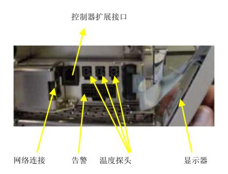
图 B1 控制器接口示意图
