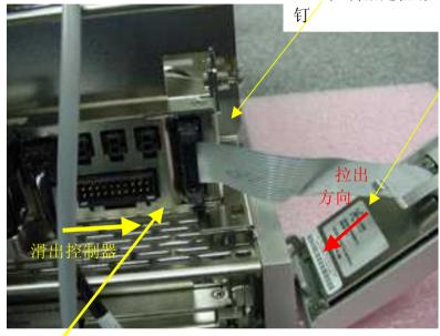
图 B4 - 更换控制器
