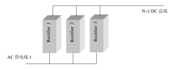
图 3 单路供电 AC 布线结构
